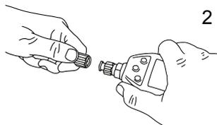
2. Alignez le G2C avec le système de raccord rapide, en vérifiant que les broches de blocage s'alignent sur les rainures de guidage.
