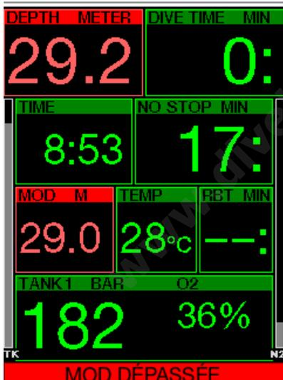
Si vous dépassez la MOD, la fenêtre de profondeur devient rouge et affiche le texte d'alarme : **MOD DÉPASSÉE**
