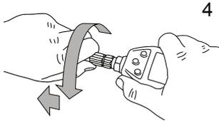
4. Tournez l'anneau de raccord rapide vers la droite, en le laissant lâche. Faites-le revenir de quelques millimètres.
