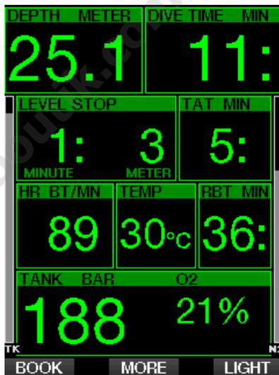
Par une pression prolongée sur le bouton MORE, le tableau du résumé des gaz s'affiche. Une pression sur le bouton MORE fait afficher les paliers de décompression prévus, avec tous les gaz activés utilisés (PMG) et avec seul le gaz actuel qui serait utilisé (1G). Le niveau MB actuellement sélectionné ainsi que les paliers prévus pour le niveau MB 0 sont également affichés.
