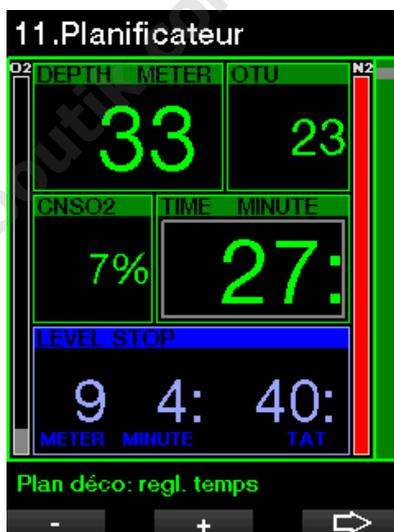
En appuyant sur le bouton FLÈCHE pour la profondeur planifiée, le temps de plongée peut être modifié. Le point de départ (maintenant le minimum) est le temps de plongée sans décompression. Le temps peut être ajouté par incréments de 1 minute. Le palier le plus profond, de décompression ou de niveau MB, est aussi inclus dans la durée totale de remontée.
