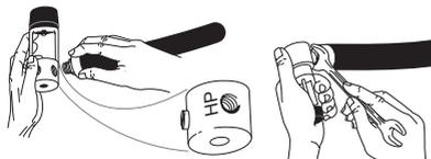
Serrez le raccord avec une clé adaptée.
