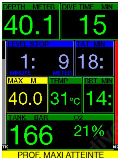
La profondeur maximale va déclencher un avertissement. Voir chapitre : **Avertissement de profondeur max.** pour savoir comment choisir la profondeur de l'avertissement.
