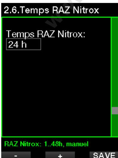
Ce temps peut être choisi entre 1 heure et 48 heures, ou sinon le temps de remise à zéro Nitrox peut être désactivé. La durée de réinitialisation des gaz est désactivée lorsque « Manuel » s'affiche.
