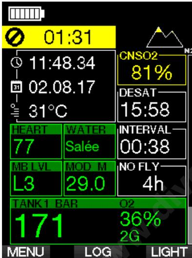
L'horloge de CNS O<sub>2</sub> augmente lorsque la pression partielle d'oxygène est supérieure à 0,5 bar, et diminue lorsque la pression partielle d'oxygène est inférieure à 0,5 bar. Par conséquent, lorsque vous respirez de l'air en surface vous diminuerez toujours le compteur de CNS O<sub>2</sub>. Pendant la plongée, la profondeur à laquelle 0,5 bar est atteint pour les différents mélanges gazeux est la suivante :
