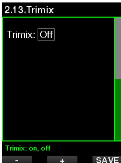
Lorsque le Trimix est sélectionné, la présentation du contenu des gaz suit l'usage pour O<sub>2</sub>/He. De même, la profondeur minimum AMD pour chacun des gaz est affichée. Voir chapitre : **Plonger avec plusieurs mélanges gazeux** pour en savoir plus sur cette fonction.
