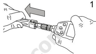
1. Faites glisser le protecteur de flexible pour accéder au système de raccord rapide.
