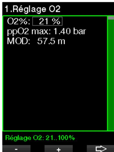
Dans ce cas, les boutons de gauche et du milieu sont marqués + et - (vous permettant de modifier la sélection en cours). La FLÈCHE à droite déplace votre sélection au champ suivant, et SAVE enregistre les valeurs indiquées. Sur le côté droit de l'écran, une barre de navigation indique la valeur sous forme analogique.
