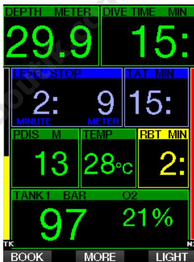
Lorsque le palier PDI calculé est à une profondeur supérieure à 8 m (25 pieds), le G2C l'affiche (fenêtre du milieu-gauche) et continue à le faire jusqu'à ce que vous arriviez à la profondeur affichée au cours de la remontée. La valeur affichée change lors de la plongée, puisque le G2C suit votre absorption d'azote dans les 16 compartiments, et met à jour la profondeur du PDIS en conséquence, afin de refléter les données optimales à tout moment.
