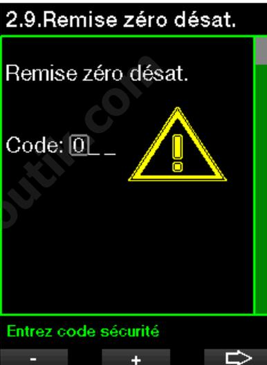
Lorsque le code de sécurité est indiqué correctement, et confirmé par une pression sur le bouton SAVE, la réinitialisation de la désaturation est effective et l'écran suivant s'affichera.
