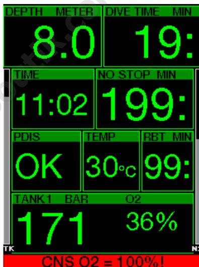
Le signal sonore se répète pendant 5 secondes à des intervalles de 1 minute, après sa première apparition, et ce tant que la valeur de la CNS O<sub>2</sub> reste à 100 % ou au-dessus, ou jusqu'à ce que la ppO<sub>2</sub> chute au-dessous de 0,5 bar (voir chapitre **Plonger avec le Nitrox** pour une liste des profondeurs auxquelles la PPO<sub>2</sub> est égale à 0,5 bar pour certains mélanges Nitrox particuliers).
