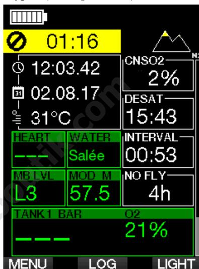
La toxicité cumulée de l'oxygène CNS% de la dernière plongée est comptée à rebours jusqu'à zéro, à côté du temps de désaturation, après quoi elle disparaît.
