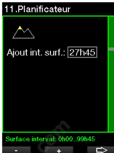
L'altitude interdite est visualisée avec le symbole de montagne, dont le pic ne doit pas être atteint par le plongeur. Pour plus d'informations sur la plongée en altitude avec le G2C, consultez le chapitre : **Plongée en altitude.**
