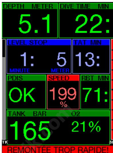
Le G2C déclenche aussi une alarme sonore en cas de vitesse de remontée dépassant 110 % : l'intensité de l'alarme augmente proportionnellement au degré de dépassement de la vitesse idéale de remontée.
