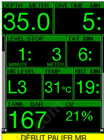
Lorsque vous plongez avec un niveau de microbulles (MB) différent de L0, le G2C peut vous avertir lorsque vous n'êtes plus en phase de plongée sans palier de microbulles. Pour plus de détails, consultez le chapitre : **Plongée avec niveaux de MB**.
