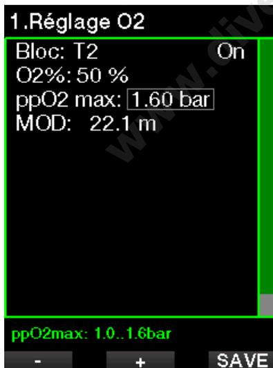
La valeur maximale de ppO<sub>2</sub> peut être modifiée dans le menu **2.4. ppO<sub>2</sub>max**.
