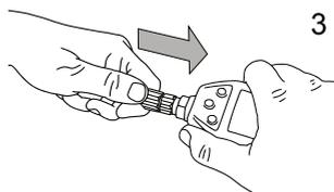
3. Poussez complètement le système de raccord rapide dans le G2C.
