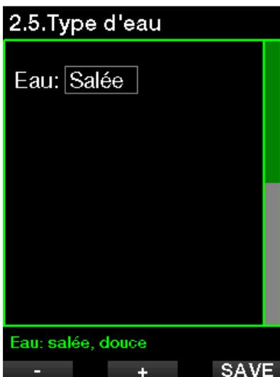
☞ *NOTE* : ce réglage ajustera la profondeur de tous les modes : Scuba et Profondimètre.
