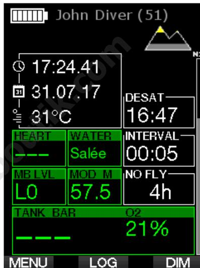
Les classes d'altitude interdites sont matérialisées par des segments jaunes (couleur des paramètres usine) à l'intérieur du symbole de montage stylisé. Cela peut être associé à des segments gris (couleur des paramètres usine) qui indiquent l'altitude actuelle. Dans l'exemple ci-dessus, le plongeur est actuellement à la classe 1 d'altitude, et ne devrait pas atteindre les altitudes situées en classe 4 ou supérieures.
