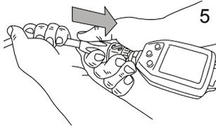
5. Vérifiez que le raccord est bien fermé en tirant et en faisant glisser le protecteur du flexible sur le système de raccord rapide
