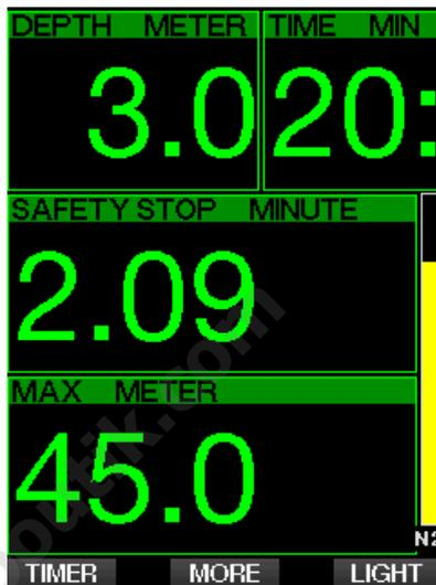
Lorsqu'il est affiché, le compte à rebours de palier de sécurité peut être arrêté par une pression sur le bouton TIMER.
