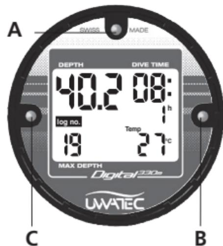
En mode Surface, si les contacts **A** et **C** sont reliés avec les doigts mouillés, Digital 330m passe en mode Carnet de Plongée. Digital 330m stocke les données des 19 plongées les plus récentes. Une plongée ne sera mémorisée dans le carnet de plongée que si sa profondeur était supérieure à 1.2 m et sa durée supérieure à 2 minutes.
