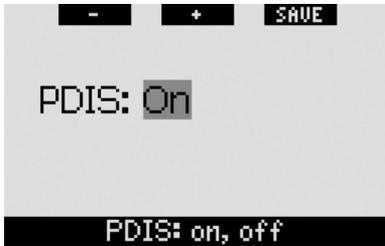
Lorsque le palier PDI calculé est à une profondeur supérieure à 8 m, Galileo l'affiche et continue à le faire jusqu'à ce que vous arriviez à la profondeur affichée lors de la remontée. La valeur affichée change lors de la plongée, puisque Galileo suit votre absorption d'azote dans les 8 compartiments, et met à jour la profondeur du PDIS en conséquence, afin de refléter les données optimales à tout moment.
