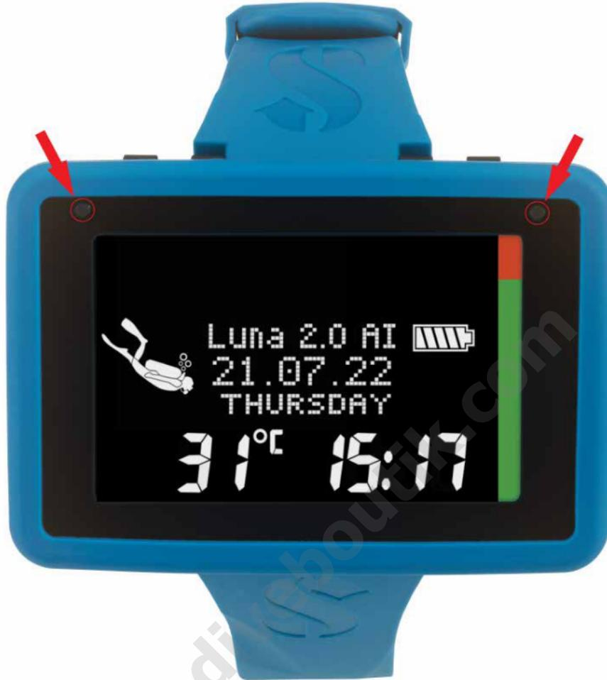
☞ **NOTE** : lors du remplacement du film de protection sur l'écran du LUNA 2.0 AI, veillez à ne pas couvrir les contacts d'activation à l'eau !
