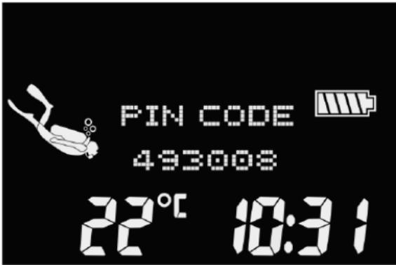
Lorsque le code est accepté par l'autre appareil, la communication est prête.
