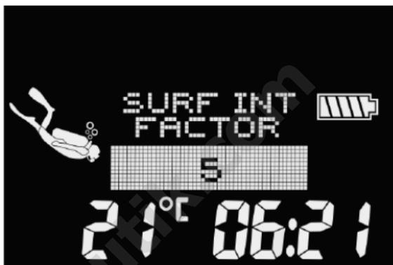
Le SIF peut être réglé entre 5 et 20 ou être désactivé par le réglage « OFF ».
