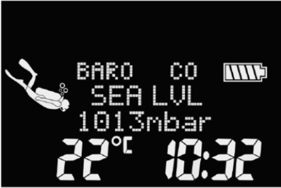
La fonction baromètre vous permet de prévoir le temps qu'il fera dans les prochaines heures si votre altitude reste identique.
