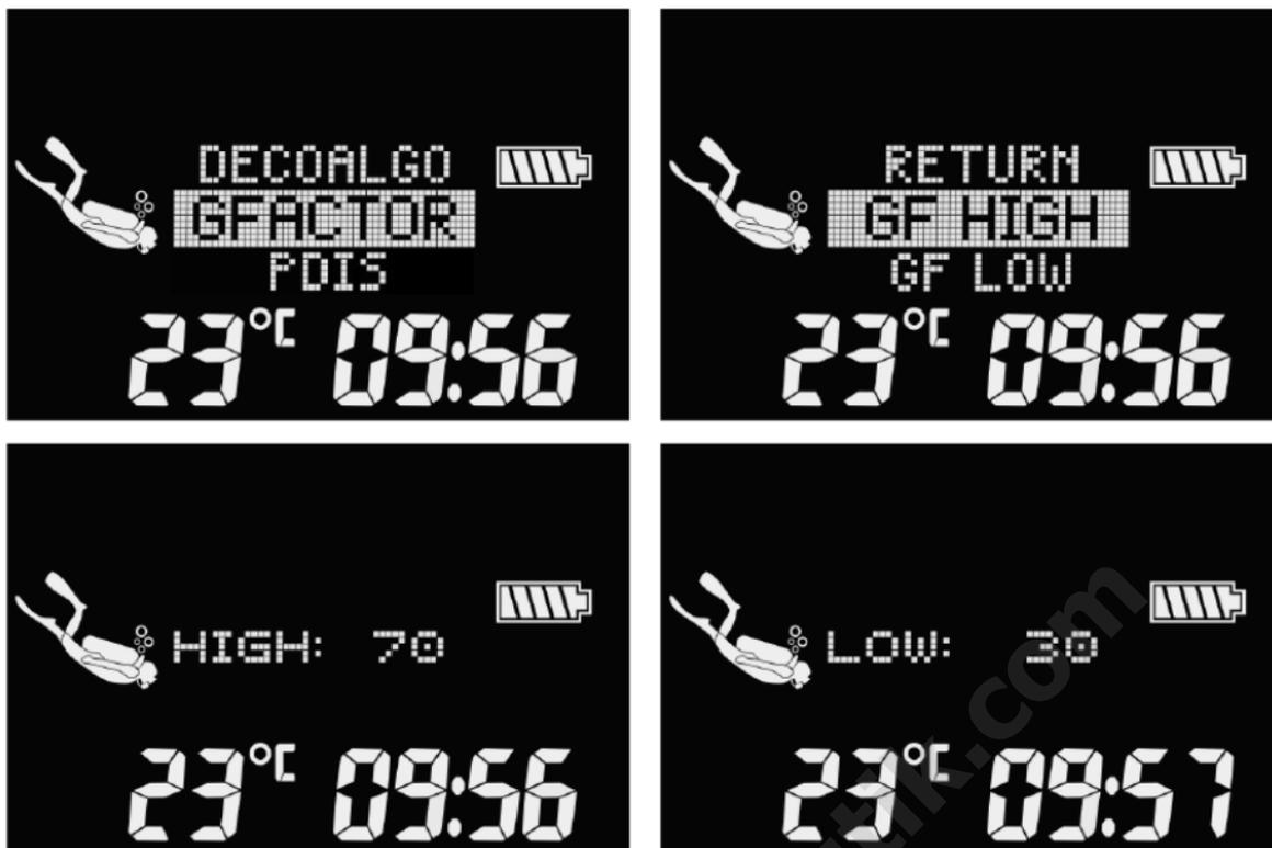
☞ NOTE : le menu GFACTOR (FGRADIENT) et les paramètres relatifs aux facteurs de gradient ne sont actifs que lorsque l'algorithme ZH-L16C+GF PMG est sélectionné dans le menu **DECOALGO** (ALGORITHME DECO).
