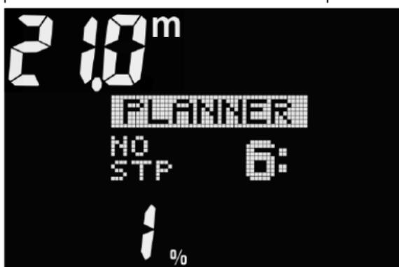
☞ *NOTE : la profondeur minimale pour une planification est de 9 m (30 pieds). Le planificateur ne permet d'utiliser que des profondeurs qui respectent la PPO<sub>2</sub> max. La part d'oxygène du mélange et les réglages de la PPO<sub>2</sub> max sont indiqués dans le menu **GAS** (GAZ).*
