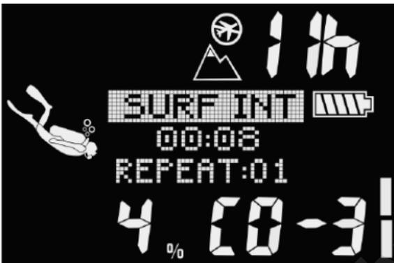
Le compteur de CNS  $O_2$  augmente lorsque la pression partielle d'oxygène est supérieure à 0,5 bar, et diminue lorsque la pression partielle d'oxygène est inférieure à 0,5 bar. Par conséquent, lorsque vous respirez de l'air en surface vous diminuerez toujours le compteur de CNS  $O_2$ . Pendant la plongée, la profondeur à laquelle 0,5 bar est atteint pour les différents mélanges gazeux est la suivante :
