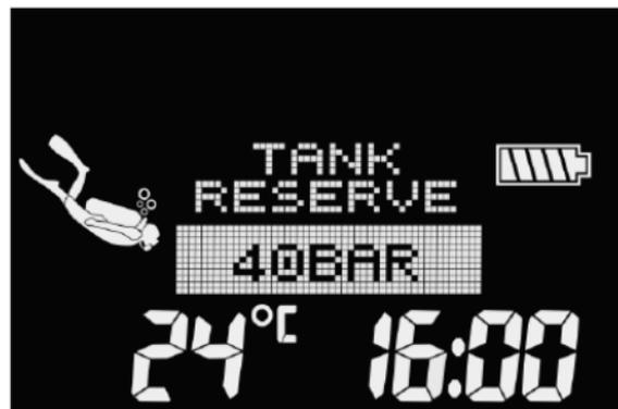
☞ **NOTE** : une alarme se déclenche lorsque la pression de réserve du bloc est atteinte. Dans le calcul de la véritable autonomie restante (RBT), la pression de réserve de la bouteille définit un bloc entièrement utilisé. La pression de réserve doit toujours être conservée dans le bloc lors de l'arrivée en surface.
