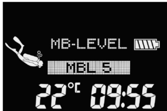
☞ NOTE : le menu **MB-LEVEL** (NIVEAU DE MB) et les réglages liés aux niveaux de microbulles ne sont actifs que lorsque l'algorithme ZH-L16 ADT MB PMG est sélectionné dans le menu **DECOALGO** (ALGORITHME DECO).
