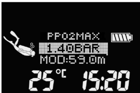
☞ NOTE : la  $ppO_2$  est fixée à 1,60 bar lorsque la proportion d'oxygène sélectionnée est de 80 % ou plus.
