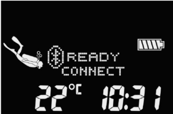
☞ **NOTE :** la connexion Bluetooth expire au bout de 3 minutes si elle n'est pas active avec le LUNA 2.0 AI. Après cet intervalle, le LUNA 2.0 AI désactive Bluetooth et revient à l'écran surface afin d'économiser de l'énergie.
