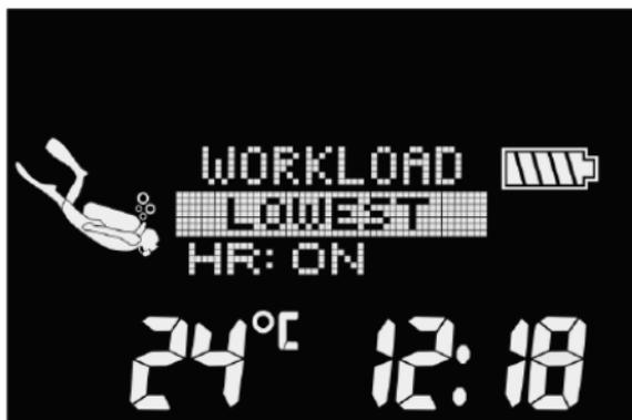
Lorsque la fréquence cardiaque n'est pas utilisée en tant que paramètre d'effort (WORKLOAD OFF), les valeurs de fréquence cardiaque peuvent tout de même être affichées à l'écran au cours de la plongée. Cela peut être choisi dans le champ du bas, où HR peut être réglé sur ON ou OFF.
