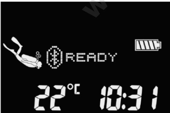
Pour établir une connexion Bluetooth avec un autre appareil, mettez cet appareil (par exemple un appareil mobile iOS® ou Android) en mode « scan ». La première fois, cela exigera d'entrer un code de sécurité pour garantir que la communication est sécurisée. Le code de sécurité est généré de manière aléatoire par votre LUNA 2.0 AI et s'affiche sur son écran.
