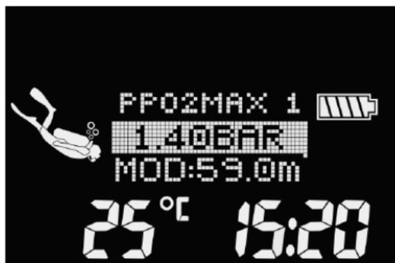
☞ NOTE : sur cet écran, la MOD est également affichée et s'ajustera automatiquement en fonction de vos paramètres PPO<sub>2</sub>max.
