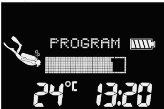
**NOTE :** le LUNA 2.0 vérifie l'état de sa batterie avant de procéder à la mise à jour. Si le niveau de la batterie est
