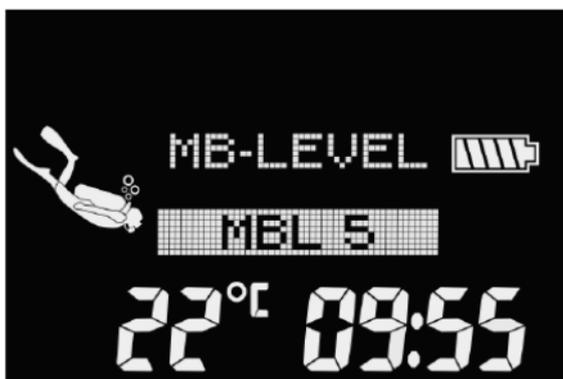
☞ NOTE : le menu **NIVEAU DE MB (MB-LEVEL)** et les réglages liés aux niveaux de microbulles ne sont actifs que lorsque l'algorithme ZH-L16 ADT MB PMG est sélectionné dans le menu **DECOALGO (ALGORITHME DECO)**.
