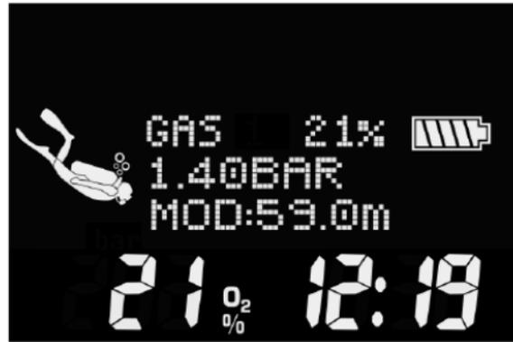
Après la fin d'une plongée, le profil de plongée ainsi que des données telles que la profondeur maximale, le temps total de plongée et la température seront affichés. Appuyez sur les boutons poussoirs de gauche ou de droite pour commencer ou terminer la plongée. Ces informations sont les mêmes que celles affichées dans le carnet interne du LUNA 2.0 (voir le chapitre **Lecture du carnet**). Par une pression longue sur le bouton de droite, vous pouvez quitter les informations du carnet.
