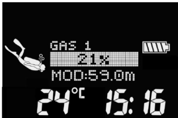
☞ **NOTE** : dans cet écran, la MOD est également affichée, et s'ajustera automatiquement en fonction de vos paramètres O<sub>2</sub> et PPO<sub>2</sub>max.
