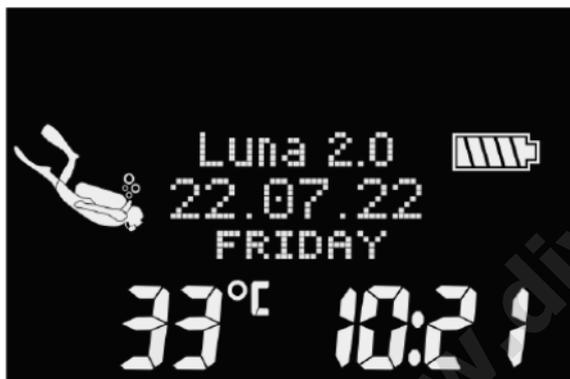
Sur cet écran de surface, s'il reste de la saturation de la dernière plongée ou du fait d'un changement d'altitude, le LUNA 2.0 peut afficher l'icône d'interdiction de vol, celui d'interdiction de plonger, l'icône d'altitude, ou une combinaison des trois en fonction des circonstances
