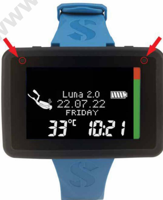
☞ **NOTE** : lors du remplacement du film de protection sur l'écran du LUNA 2.0, veillez à ne pas couvrir les contacts d'activation à l'eau !
