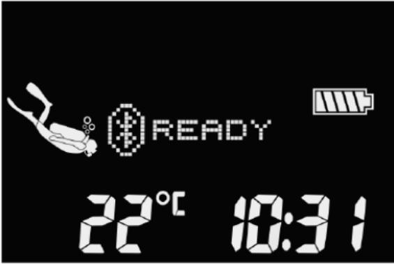
Pour établir une connexion Bluetooth avec un autre appareil, mettez cet appareil (par exemple un appareil mobile iOS® ou Android) en mode « scan ». La première fois, cela exigera d'entrer un code de sécurité pour garantir que la communication est sécurisée. Le code de sécurité est généré de manière aléatoire par votre LUNA 2.0 et s'affiche sur son écran.
