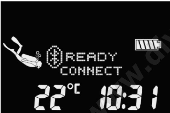
☞ *NOTE : la connexion Bluetooth expire au bout de 3 minutes si elle n'est pas active avec le LUNA 2.0. Après cet intervalle, le LUNA 2.0 désactive Bluetooth et revient à l'écran surface afin d'économiser de l'énergie.*
