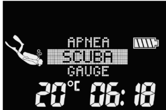
☞ **NOTE** : les modes GAUGE et APNEA ne gèrent pas la saturation des tissus, et il y a un intervalle de blocage avant de pouvoir revenir au mode SCUBA. L'intervalle de blocage est de 48 heures après la dernière plongée en mode GAUGE. Il y a un intervalle de blocage de 12 heures si la profondeur des plongées en mode APNEA a été inférieure à 5 m (16 pieds) et 24 heures si elles ont été plus profondes que 5 m (16 pieds).
