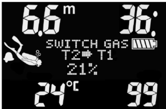
Une pression longue sur le bouton de droite confirme le passage, et une pression brève sur les boutons de droite ou de gauche permet de choisir un mélange gazeux différent.
