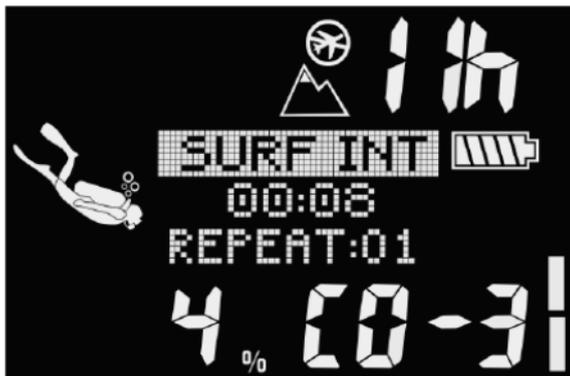
Le compteur de CNS O<sub>2</sub> augmente lorsque la pression partielle d'oxygène est supérieure à 0,5 bar, et diminue lorsque la pression partielle d'oxygène est inférieure à 0,5 bar. Par conséquent, lorsque vous respirez de l'air en surface vous diminuerez toujours le compteur de CNS O<sub>2</sub>. Pendant la plongée, la profondeur à laquelle 0,5 bar est atteint pour les différents mélanges gazeux est la suivante :
