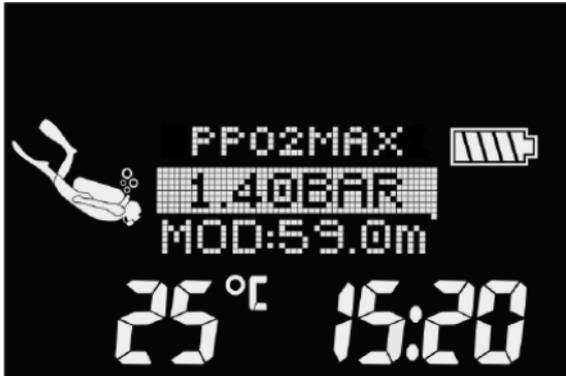
☞ NOTE : la ppO<sub>2</sub> est fixée à 1,60 bar lorsque la proportion d'oxygène sélectionnée est de 80 % ou plus.
