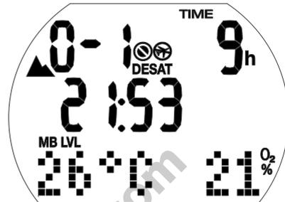
À partir de l'affichage de l'heure du jour, vous pouvez vérifier le temps de désaturation\* par une pression prolongée sur le bouton de droite. Le temps de désaturation est déterminé soit par la toxicité de l'oxygène, soit par la saturation en azote, ou par la diminution des microbulles, en fonction de ce qui demande le plus de temps.
