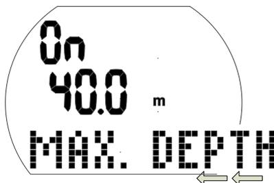
1. Confirmez que vous désirez modifier la profondeur de l'avertissement de profondeur maximale de plongée par une pression prolongée du bouton de droite. « On » ou « Off » se met à clignoter. « On » signifie que la fonction est activée, « Off » qu'elle est désactivée.
