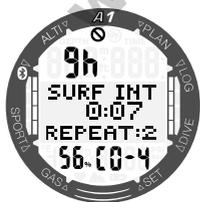
Le compteur de CNS  $O_2$  augmente lorsque la pression partielle d'oxygène est supérieure à 0,5 bar et diminue lorsque la pression partielle d'oxygène est inférieure à 0,5 bar. Par conséquent, lorsque vous respirez de l'air en surface vous diminuerez toujours le compteur de CNS  $O_2$ . Pendant la plongée, la profondeur à laquelle 0,5 bar
