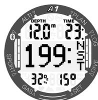
Durée de plongée sans palier, c'est le temps qu'il est possible de passer à la profondeur actuelle sans qu'il soit nécessaire d'effectuer un palier de décompression.
