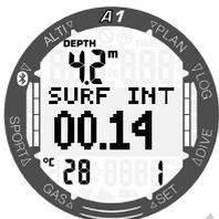
Par une pression sur le bouton -/DOWN depuis l'affichage de l'intervalle de surface, la profondeur maximale (4 m) et la durée de la dernière plongée (01:13 min), et la durée totale de l'exercice actuel d'apnée (00:04) sont affichés.
