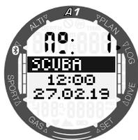
Une pression sur le bouton SEL/ESC alors que vous êtes sur l'écran ci-dessus fera afficher le profil graphique de la plongée sur l'A1. Cet écran affiche les informations suivantes : profondeur maximale, durée totale de la plongée et température minimale de l'eau.
