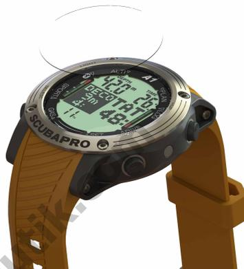
**NOTE :** si des bulles d'air restent coincées sous le film de protection lorsque vous appliquez celui-ci sur la vitre de l'A1, n'essayez pas de les retirer car la pression de l'eau les éliminera dès la première plongée.
