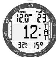
Durée totale de remontée, c'est le temps nécessaire pour remonter en surface, y compris les possibles paliers.
