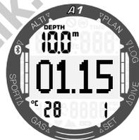
Comme pour le mode Profondimètre, l'A1 en mode Apnée (APNEA) n'effectue pas de calculs de décompression. Vous ne pouvez passer en mode apnée Apnée (APNEA) que si l'ordinateur est complètement désaturé. De plus, l'A1 reste bloqué en mode Apnée (APNEA) pendant 12 heures après des plongées à des profondeurs de moins de 5 m et 24 heures si les plongées les plus profondes ont dépassé 5 m.
