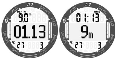
Au cours d'une plongée en apnée, ces deux écrans affichent la profondeur de la plongée actuelle et sa durée, et il est possible de les faire défiler à l'aide des boutons +/UP ou -/DOWN.
