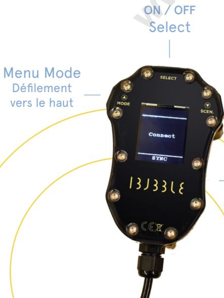
La télécommande permet le contrôle du drone une fois immergé. Les boutons permettent de naviguer dans les différents menus.
