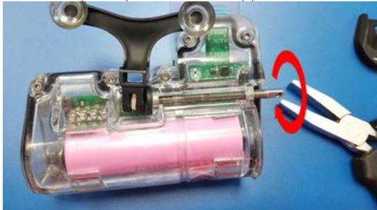
4 – Echanger le support de ventouses, replacer la rondelle et repositionner l'axe avec quelques tours.
