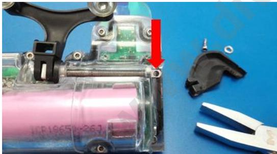
6 – Bloquer l'autre extrémité de l'axe avec un tournevis ou une cale en bois pour faire ressortir le trou de vis de la poignée.
