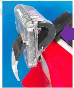
La meilleure position dépend de l'angle et de la distance entre l'optique et la vitre de votre masque. Vous avez la meilleure position quand l'ensemble de l'image est à peu près au milieu de l'optique et qu'aucun chiffre n'est masqué ou déformé
