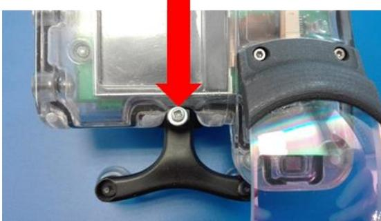
2 – Avec une clé à molette, défaire la vis à l'arrière de la poignée de verrouillage, puis retirer la poignée.
