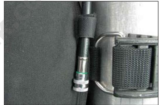
3. Otez le bouchon de protection du raccord rapide.
